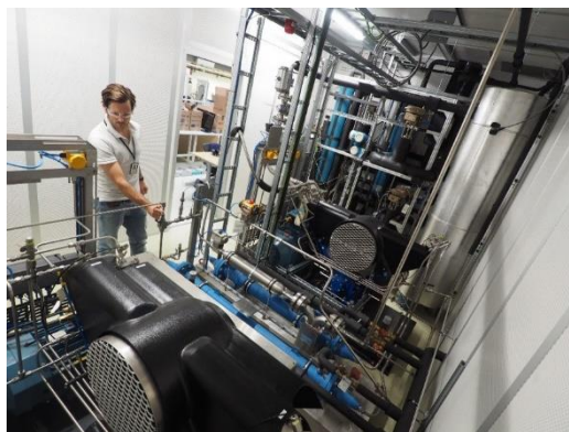
Labanlegg for separasjon og flytendegjøring av CO 2 . Foto: SINTEF
