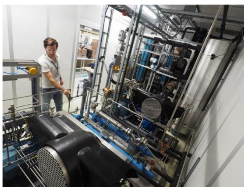
Figur 3-8: Labanlegg for separasjon og flytendegjøring av CO 2 . Foto: SINTEF
