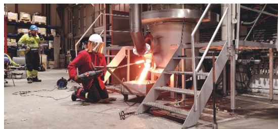
Tapping av silisium fra pilot-ovn med resirkulering av avgass. Foto: Vegar Andersen
